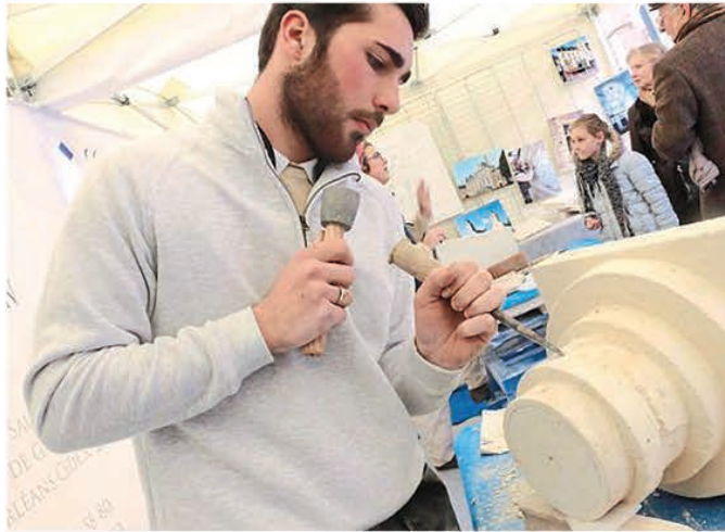
Rémi, maçon-tailleur de pierre, travaille le sireuil, pierre calcaire.
